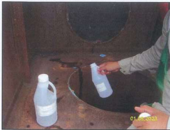
รูปที่ 2-10 การติดตามตรวจสอบคุณภาพน้ำจากกิจกรรมทดสอบการรับแรงดันของท่อและอุปกรณ์ต่างๆ ด้วยแรงดันน้ำ (Hydrostatic Test)
